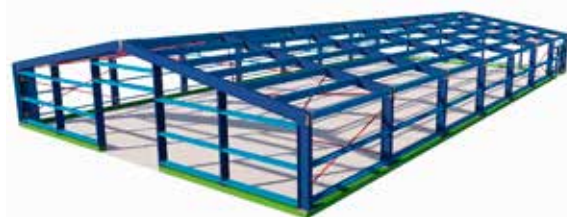
Z stálgrindarhús koma í öllum stærðum. Hér má sjá reiðhöll sem BK Hönnun ehf. flutti inn fyrir á árinu. Stærðin á húsinu eru 18x35 metrar.
