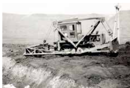
Skurðruðningstönn Haraldar í Markholti, ætluð til þess að vinna út ruðninga úr vélgröfnum skurðum og til þess að taka niður bakka þeirra. Mynd / Lbsafn.
