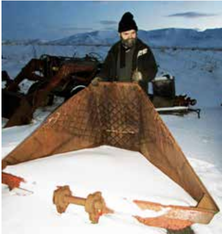
Fláaskófla Sverris Bjarnasonar. Með henni uxu afköst við vélgröft skurða. A. Grafið með fláaskóflu (Vélasjóður). B. Fláaskófla vélameistarans Hauks Júlíussonar á Hvanneyri. Mynd / BCG.
