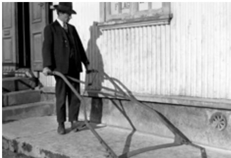
Þúfnaskeri fyrir hestadrátt, einn nokkurra gerða sem smíðaðar voru hérlendis. Myndin, sem er úr safni Árna G. Eylands, var sennilega tekin snemma á þriðja áratug síðustu aldar við hús Búnaðarfélags Íslands í Lækjargötu 14 í Reykjavík. Nafn þess sem heldur á skeranum er óþekkt.
