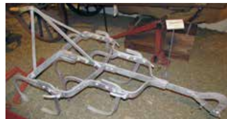
Herfin hans Lúðvíks Jónssonar, ætluð til græðisléttunar, saxherfi (A) og rótherfi (B). Mynd / Lbsafn.
