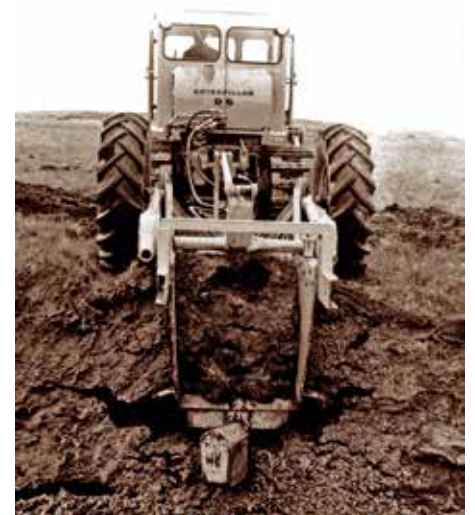
Lokræsaplógur Eggerts á Hvammstanga sem hann hlaut einkaleyfi á. A. Ræsagerð hafin við bakka opins skurðar. B. Mynd úr einkaleyfislýsingunni. Mynd / Lbsafn.
