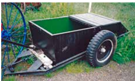
Mykjudreifari Guðmundar ráðsmanns á Hvanneyri. Dreifarinn fyllti sig og tæmdi fyrir afl dráttarvélarinnar. Mynd /A. Lbsafn, B. BG.
