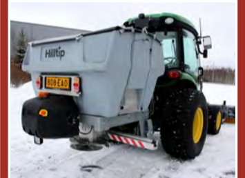
Hilltip Icestriker 600 TR Rafdrifinn kastdreifari fyrir dráttarvélar m/öflugum efnisskömmunarbúnaði.
