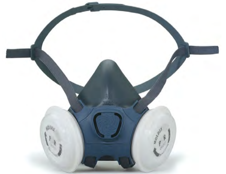
Rykgrímur eru mismunandi að gæðum. Fyrir vinnu í fjósum ætti ekki að nota grímur sem eru með lægri rykstöðvunarstuðul en P2 og við háþrýstipvott á að nota tegundir sem kallast P3.
