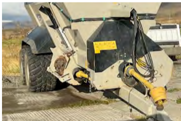
Til sölu Shelbourne Reynolds skítadrefari, árg. 2020. Dreifarin kastar út á hægri hlið. Dekk 750/45R22,5. Sver snigill í botninum sem færir skitinn að kastromlunni. Getur dreift 10-15 metra. Sterkur og einfaldur í notkun og fátt til að bíla. Tekur um 12 rúmmetra og burðargeta 9 tonn. Dreifarin er staðsettur á Kjálarnesi og er í finu lagi. Ásett verð kr. 4.500.000 +vsk. Upplýsingar í s. 822-8612, Bjarni.
