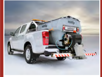
Hilltip Icestriker 380–550L Salt og sanddreifarari í tveim stærðum, fyrir minni pallbíla. Rafdrifinn 12V.
