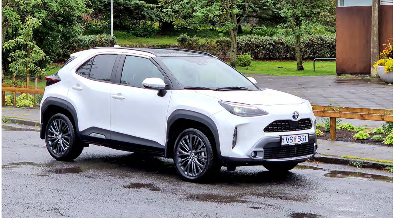
Toyota Yaris Cross er fjórhjóladrífinn tvinnbíl þar sem afturhjólin eru knúin með rafmótor, á meðan framhjólin eru knúin af bensínmotorum. Þetta er bíll með góða aksturseginnleika á fjölbreyttum. Veikasti hlekurinn er hátt verð í samanburði við betur búna rafmagnsbíla. Myndir / AL
