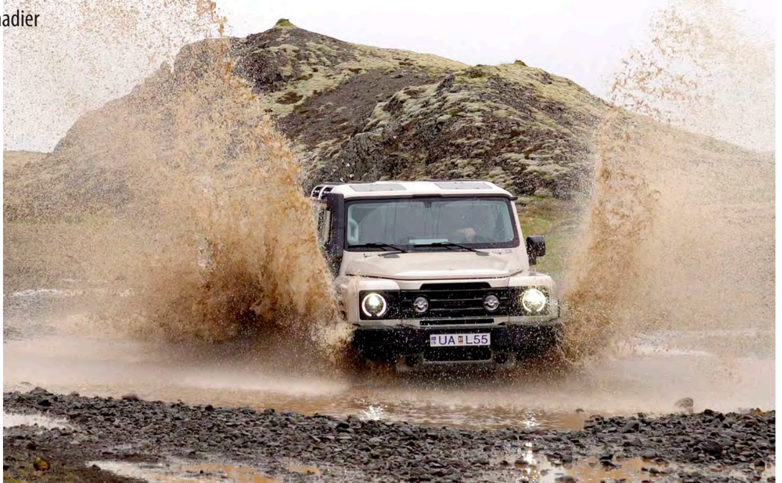
Ineos Grenadier er nýr jeppi af gamla skólanum. Öll hönnun bílsins miðar að því að gera eins gott torfærutæki og kostur er. Hann kemur byggður á grind, með hásingar að framan og aftan, ásamt læstum millikassa og driflæsingum að framan og aftan. Mynd / Daniel Freyr Árnason
