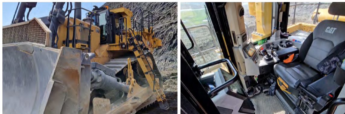
Öflugur landgangur gefur gott aðgengi. Vökvaðmótorar slaka honum niður. Öikumannshúsið er góður staður til að vera á. Mikil hljóðeinangrun gerir aðstöðuna vistlega. Sætið fjáðrar og er stillanlegt.
