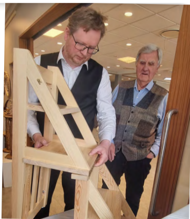
Einar Jónasson, leiðbeinandi í smíðastofu Árskóga sýnir hér sniðugan stól sem hægt er að breyta í tröppu sem Hafsteinn Ársælsson smíðaði.
