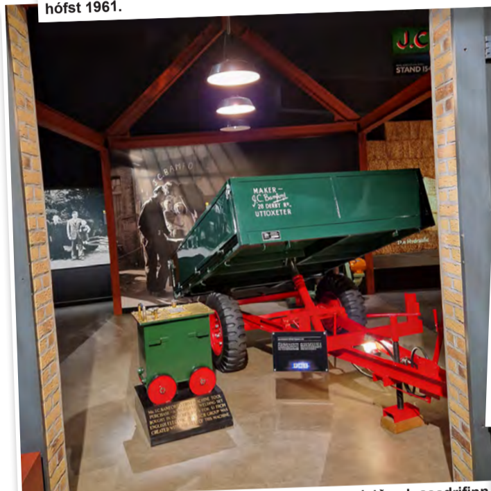
Joseph Cyril Bamford (JCB) var fyrstur til að framleiða glussadrifinn sturtuvagn árið 1948.
