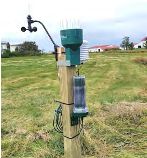
Sjálfvirk sólardrifin veðurstöð í Þykkvabæ til mælinga á mygluhættu.
