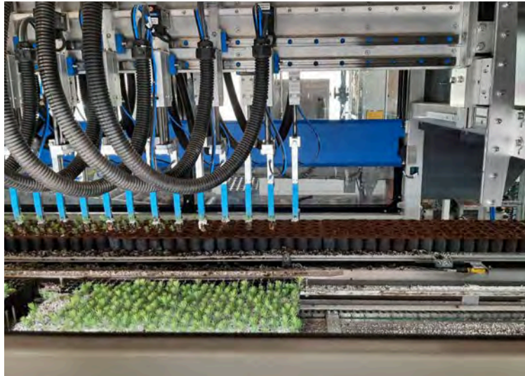
Hinn snjalli og afkastamikli priklunar-róbót í Sólskógum gerir stöðinni kleift að framleiða um sjö milljónir plantna fyrir næsta ár, mest birki og stafafuru en einnig lerki, ösp og sitkagreni.
