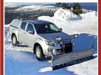
Hilltip Snowstriker SP Snjótönn fyrir pallbíla, minni vörubíla og jeppa. Fáanleg í 165–240 cm breidd.
